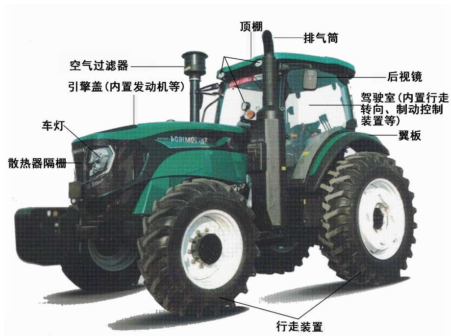
图 2-2 农用拖拉机总体构造示意图
