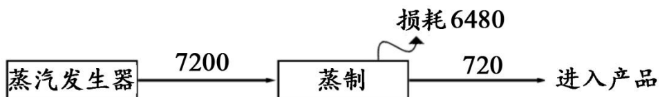
图 2-3 本项目蒸汽平衡图（单位： \text{t}/\text{a} ）
